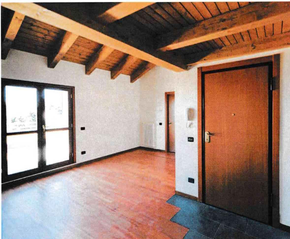
I sistemi serramento-vetro, ad alta efficienza, sono in **legno pino di Svezia** finito mordenzato con **spessore maggiorato** (68 mm) e guarnizioni di tenuta antispiffero; uniscono al pregio estetico e alla capacità di armonizzarsi perfettamente con ogni tipo di arredamento, robustezza, tenuta agli agenti atmosferici e isolamento termo-acustico.
